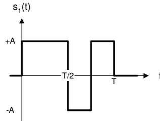
Gegeben ist die Pulsform  $s_1(t)$  der Dauer  $T$ , welche zur Übertragung des binären Symbols  $b$  verwendet wird. Das Sendesignal  $s(t)$  wird nach der Regel
