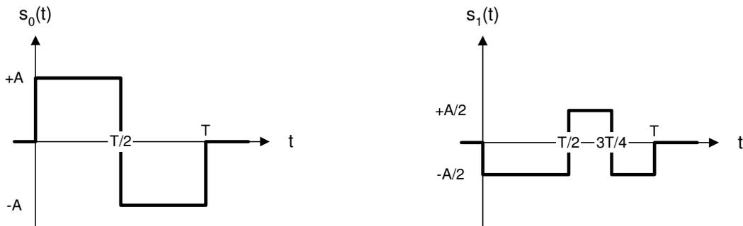
Gegeben sind die zwei Pulsformen  $s_0(t)$  und  $s_1(t)$  der Dauer  $T$ , welche zur Übertragung des binären Symbols  $b$  verwendet werden. Das Sendesignal  $s(t)$  wird nach der Regel
