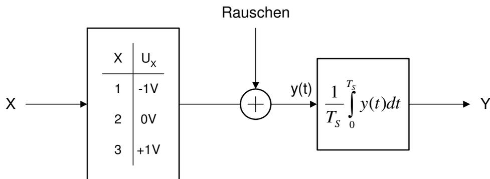
Wir betrachten eine dreiwertige Pulsamplitudenmodulation. Die drei Nachrichtensymbole werden mit den drei Spannungswerten  $U_1 = -1$  V,  $U_2 = 0$  V und  $U_3 = +1$  V übertragen. Im Empfänger wird das Empfangssignal  $y(t)$  während einer Symbolperiode gemittelt. Der dadurch gewonnenen Entscheidungsvariable  $Y$  ist ein Rauschen mit der Wahrscheinlichkeitsdichte
