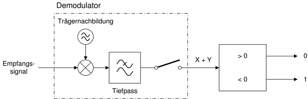
Wir betrachten eine Übertragung mit binärer Phasenumtastung (BPSK). Im Demodulator wird aus dem Empfangssignal eine Entscheidungsvariable  $Y$  berechnet. Diese nimmt den Wert  $Y_0 = +A/2$  an, falls eine 0 gesendet wurde und  $Y_1 = -A/2$ , falls eine 1 gesendet wurde. Zusätzlich ist der Größe  $Y$  ein Rauschen  $X$  mit der Wahrscheinlichkeitsdichte
