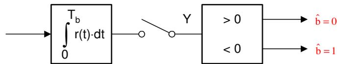
**Figur 46:** Aufbau des optimalen Empfängers
