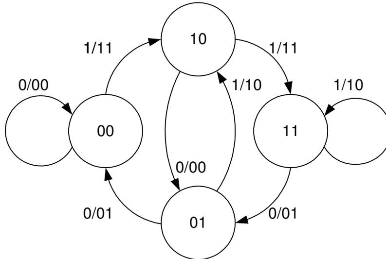
b) Die Sequenz  $r[.] = (10\ 00\ 10\ 01\ 01\ 01)$  wird empfangen. Bestimmen Sie mit Hilfe des Viterbi-Algorithmus den wahrscheinlichsten Pfad durch den Trellis, falls der Startzustand mit 00 angenommen wird.
